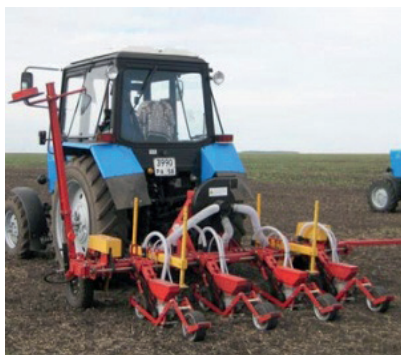
Шолғом уруғларини СОНП-2,8 сеялка ёрдамида экиш
