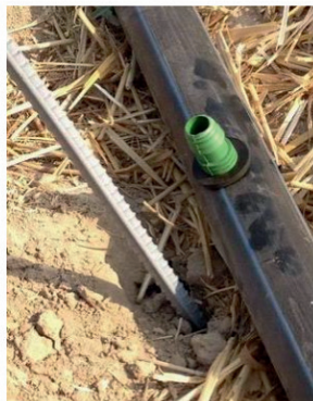
б) тарқатувчи қувурга ўрнатилган нипелли штуцер
