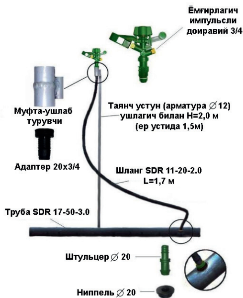
а) ёмғирлатгич мосламасининг умумий кўриниши (қисмлари билан)
